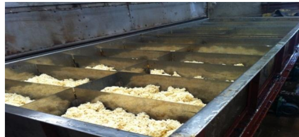
Hình 1.4c. Hệ thống máy cán và băm cốm sẽ làm việc 1 cách tự động để tạo ra cốm theo tiêu chuẩn, và được đưa vào các thùng đựng cốm
