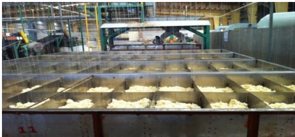
Hình 1.4c. Hệ thống máy cán và băm cốm sẽ làm việc 1 cách tự động để tạo ra cốm theo tiêu chuẩn, và được đưa vào các thùng đựng cốm
