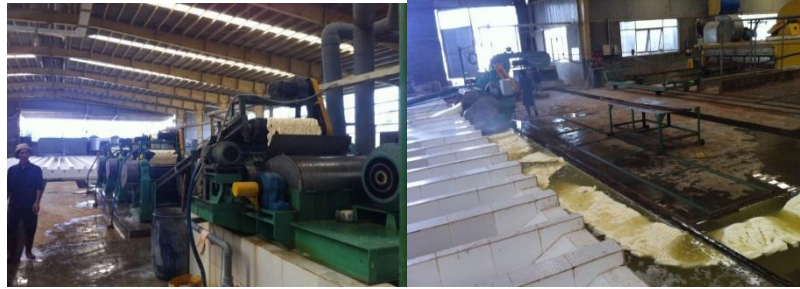
Hình 1.4b. Sau khi mủ đã được đánh đông, máy cán kéo sẽ kéo mủ đông từ mương đưa vào hệ thống máy sản xuất
